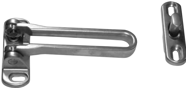
ドアガード(外開用)耐震ドア対応型 受座可動(内面変形許容量 9mm)
