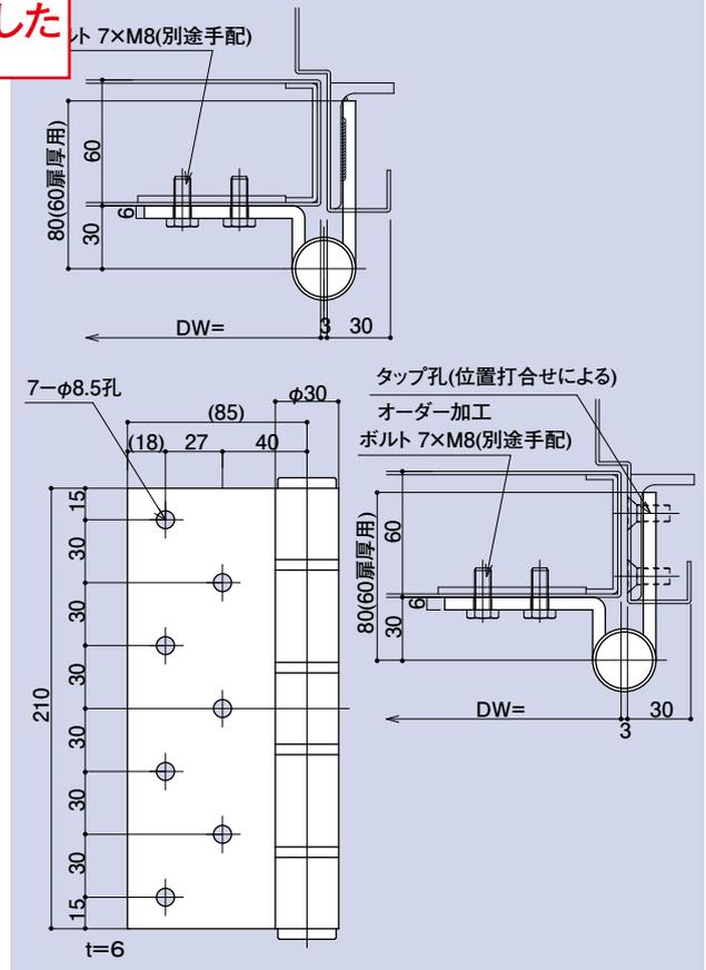
210大型丁番ボルトタイプ オーダーで枠側タップ孔加工いたします。
